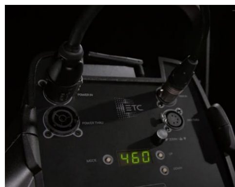
Displej s tlačítky pro nastavení a lokální ovládání zoomu
