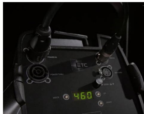
Displej s tlačítka pro nastavení a lokální ovládnání zoomu
